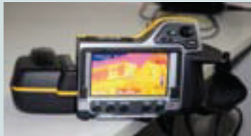
Abb. 1 Thermografie mit Hilfe einer Infrarotkamera © SAENA
