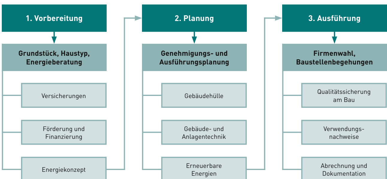
Abb. 4 Ablaufplan eines Neubau- oder Sanierungsvorhabens
