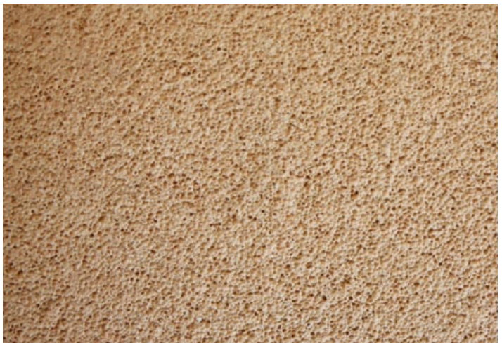
Abb. 8 Offenporige Oberfläche einer Mineralschaum-Platte
