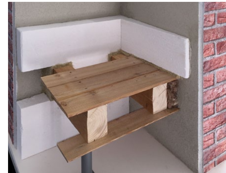
Abb. 42 Detail Innendämmung – Bereich Holzbalkendecke und einbindende Innenwand
